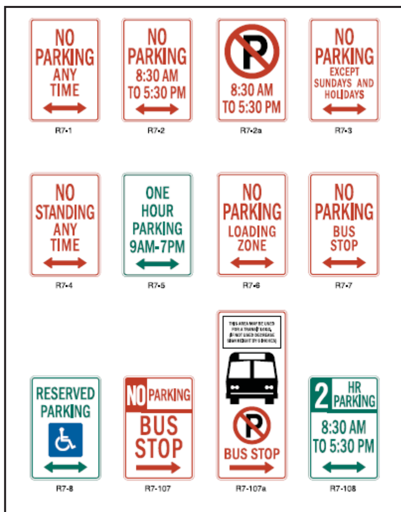
شکل (۴-۱۱). نمونه ای از تابلوهای کنترل پارکینگ.
