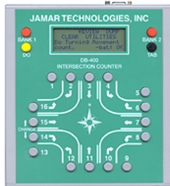
شکل (۸-۱۰): شمارشگر الکترونیکی دارای مبدل اطلاعات برای مطالعات تقاطع
